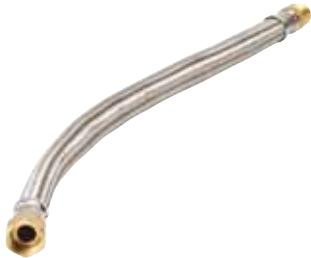
Las mangueras de serpentín Victaulic incluyen una manguera trenzada de acero inoxidable y un núcleo de polímero sintético con férulas de acero inoxidable. Hay disponibles mangueras de serpentín Victaulic con conexión giratoria macho x hembra y conexión giratoria macho x macho. Las mangueras de serpentín Victaulic vienen en tres longitudes: 12"/300 mm, 24"/610 mm o 36"/914 mm. Especifique su opción en el pedido.
