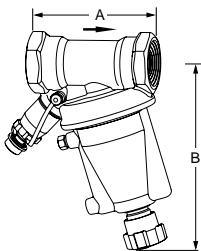
Los controladores TA de presión diferencial vienen por defecto con un kit de drenaje, un puerto de medición, un niple de transición y una herramienta de ajuste. La conexión de extremo en tamaños  $\frac{1}{2}''/15$  mm a  $2''/50$  mm son todas roscas IPS hembra solamente. Las soldadas no están disponibles.
