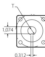
BRIDA DE MONTAJE EXPANDIDA TÍPICO DE TAMAÑO DE 10"/250 mm
