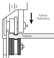
El ranurado por laminación no remueve metal de la tubería
