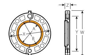
Para un sellado eficaz, el área anaranjada de la cara acoplada no debe tener perforaciones, ondulaciones ni deformidades de ningún tipo.
