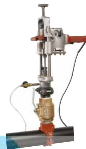
La herramienta Vic-Tap es perfecta para aplicaciones en que los sistemas no se pueden sacar de servicio para agregar conexiones de derivación. Capaz de perforar derivaciones en sistemas de tuberías de acero a presiones de 500 psi/3450 kPa, la herramienta Vic-Tap reduce automáticamente la parte desprendible de la tubería y evita posibles daños a equipos en la tubería, vea la pág. 20-11.
