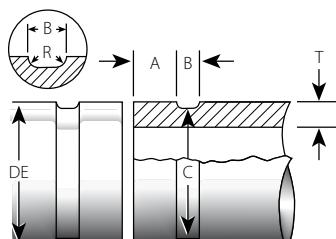
ESPECIFICACIONES DE RANURADO POR CORTE RADIAL PARA UNIÓN FLEXIBLE – TUBERÍA DE HIERRO DÚCTIL®
