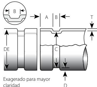
ESPECIFICACIONES DE RANURADO POR LAMINACIÓN DE TUBERÍAS DE COBRE @
