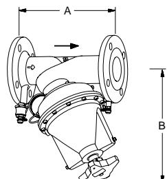
Los controladores TA de presión diferencial vienen por defecto con un kit de drenaje, un puerto de medición, un niple de transición y una herramienta de ajuste. Las conexiones de extremo son bridas ANSI solamente, los extremos ranurados no están disponibles.
